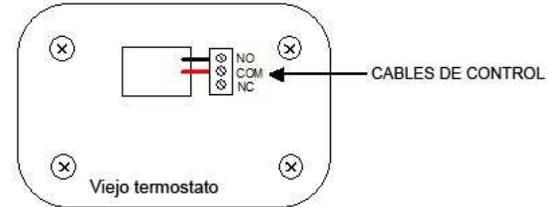
Si el termostato que vamos a substituir tiene conectados 4 cables, será necesario diferenciar entre los cables de control y los cables de alimentación (corriente eléctrica). Ver imagen a continuación.
